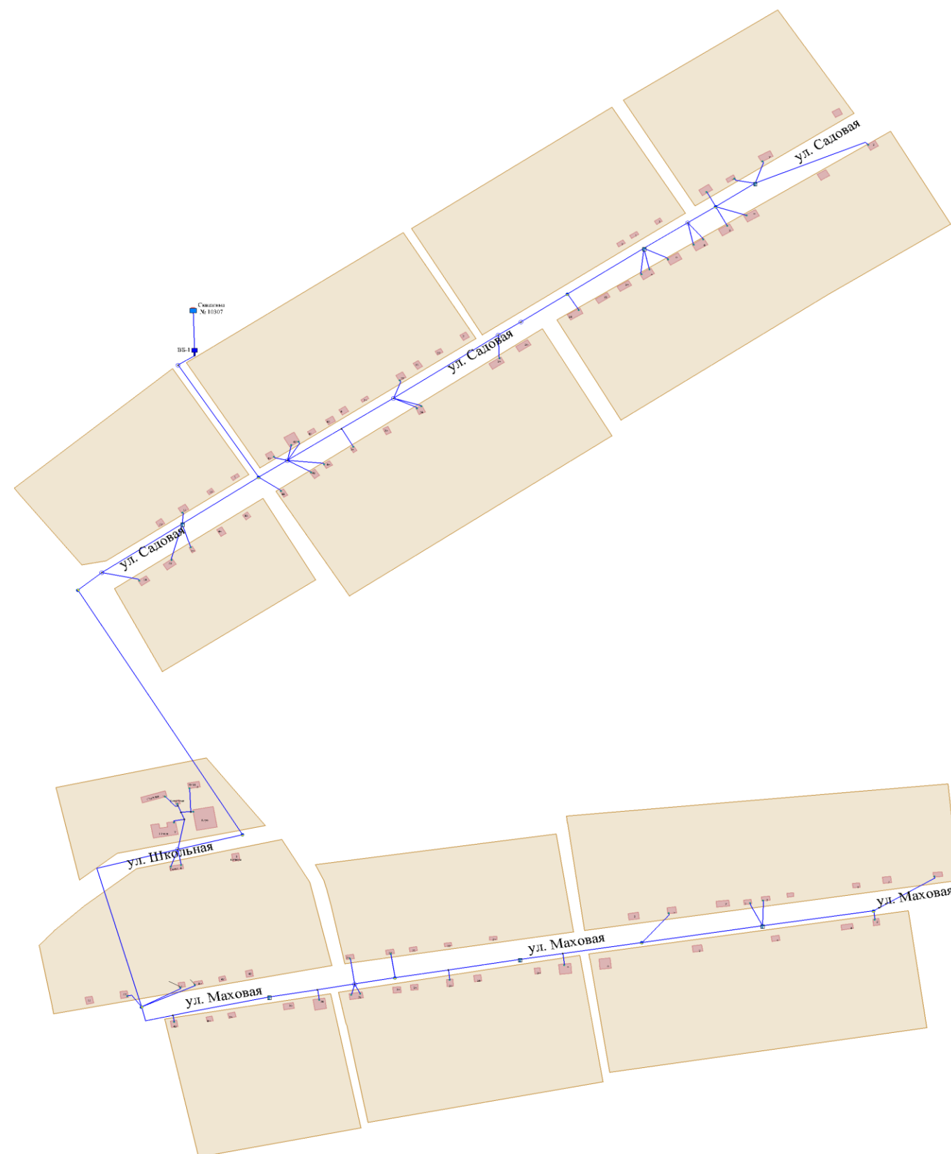
Рисунок 2.1 – Зона централизованного водоснабжения д. Пензино
